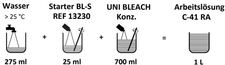
Der Ansatz der Arbeitslösung kann in einem separaten Mischer oder direkt im Arbeitstank der Maschine erfolgen. Voraussetzung für den Ansatz im Arbeitstank ist Kenntnis des genauen Tankinhalts. Der Farbentwickler-Arbeitstank muss perfekt abgedeckt werden, um eine mögliche Verunreinigung mit Bleichbad sicher auszuschließen.
